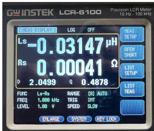
**Gesamtwiderstand:  $0,00041 \Omega = 0,41 \text{ m} \Omega = 410 \mu \Omega$**
